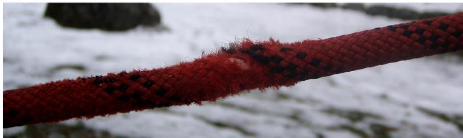
Bilde 38: Eksempel på skadd strømpe på taubrutau.
