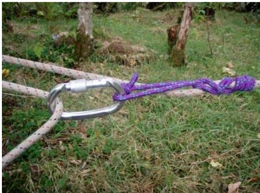
Avstanden frå slynga på treet til klemknuten er avhengig av lengda på taubrua. Er det kort avstand mellom trea bør det vere kort avstand til klemknuten. Unngå unødig lange avstandar til klemknuten fordi du då får større område der taua kan gnisse mot kvarandre og gi klemfare. Ofte passar det å legge klemknuten i ein avstand frå 1 – 2 meter frå festepunktet til det siste treet.
