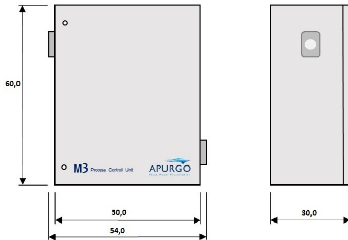
Figur 1 - Styringskap for M3-5, M3-25 og M3-50, mål i cm
